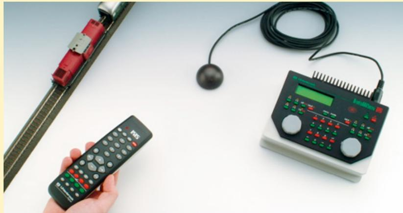
erfolgt über die LocoNet-Buchse am Empfänger des IRIS-Sets. Die Anzeigeneinheit kann als Display für den Infrarotregler dienen, doch auf Wunsch auch andere Dinge wie die Stellung der wichtigsten Weichen anzeigen. Für Freunde des Fahrplanbetriebs lässt sich eine Modelluhr einblenden.
