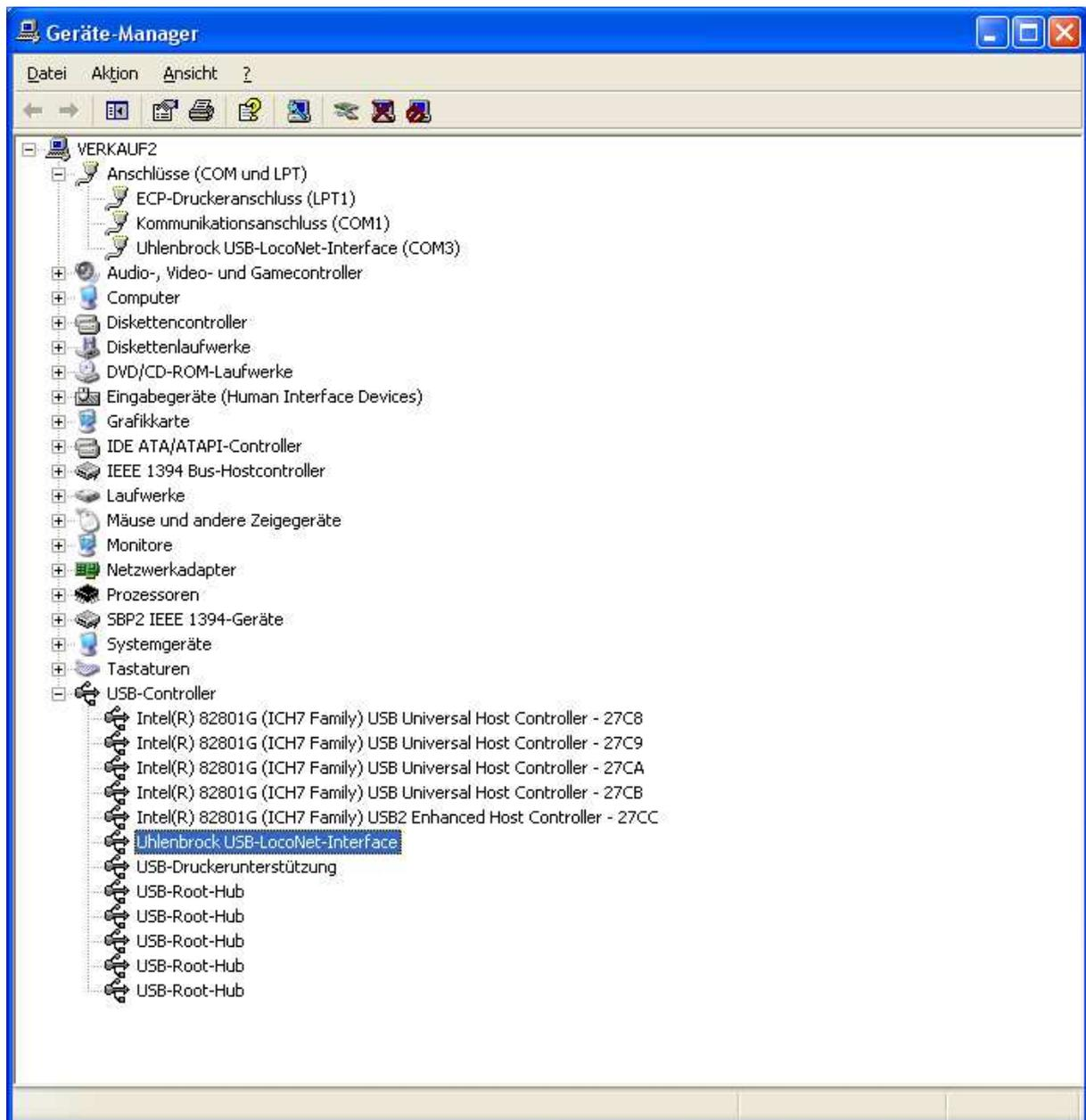
Uhlenbrock USB-LocoNet-Interface (z.B. COM3) wird angezeigt.
