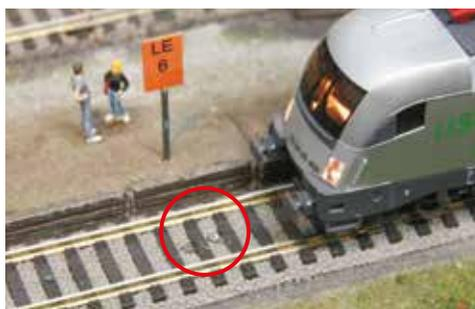
Beim der Automatisierungssysteme »LISSY« oder »MARCo« werden die Zugnummern der Züge angezeigt, die den zugeordneten Sensor des LISSY- oder den Gleisabschnitt des MARCo-Systems passieren. Das kann z. B. am Ausfahr-gleis eines Bahnhofs stattfinden.
