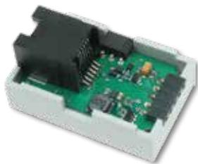
Das Track-Control-Anschlussmodul verbindet das Pult direkt mit dem LocoNet. Die Energieversorgung des Pultes erfolgt direkt aus dem LocoNet.
