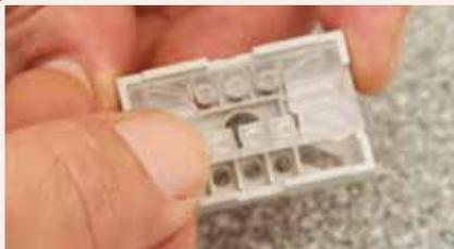
**Drehen Sie** die Segmente um. Legen Sie die Streuscheiben, falls benötigt die Tastenkappen, und die Platinen in die Segmente.
