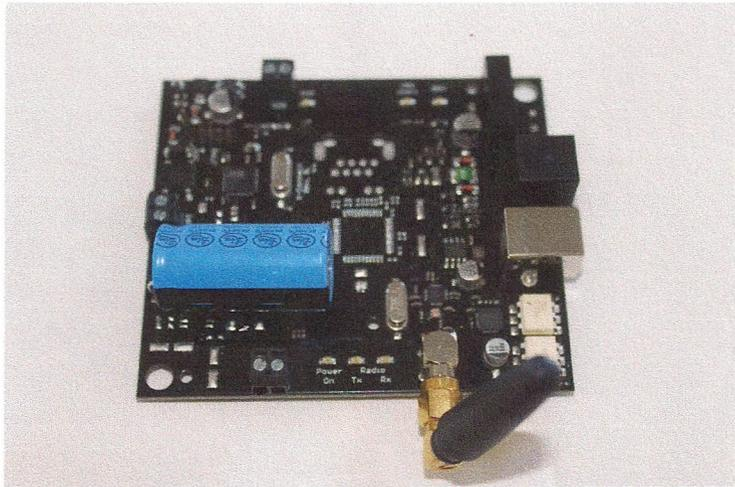
**1307910, 1307911 Masterplatine mit Funkantenne**
