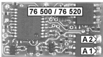
Zusätzliche Sonderfunktionen wie Rauchgenerator, Telexkupplung oder eine Führerstandsbeleuchtung können an die Sonderfunktionsausgänge A1 und A2 angeschlossen werden. Die Zuleitung des Verbrauchers wird direkt an die Decoderplatine angelötet. Die Rückleitung wird entweder mit dem blauen Kabel des Decoders oder mit dem Lokchassis (Masse) verbunden.
