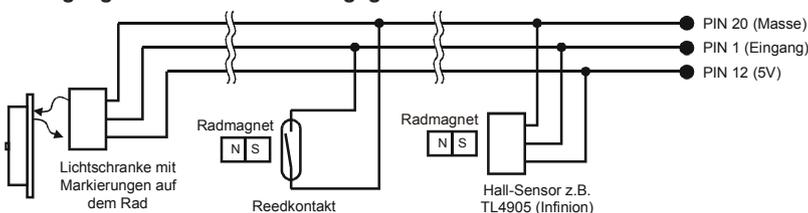
Der jeweilige Impulsgeber wird an den, in der Anschlusskizze gekennzeichneten Kontakten angeschlossen.
