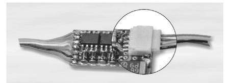
Der Reedkontakt, der Hallsensor oder die Lichtschranke werden an den in der Anschlusskizze gekennzeichneten Lötspots angeschlossen.
