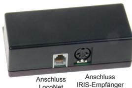
ren Empfängern zu arbeiten. Hierzu können weitere LocoNet Infrarotempfänger 63830 an das LocoNet angeschlossenen oder der Zusatzempfänger Art.-Nr. 66 520 mit seinem DIN Stecker in die Buchse „Zusatzempfänger“ des LocoNet Infrarotempfängers 63830 gesteckt werden. An die DIN-Buchse „Zusatzempfänger“ können über das dem Zusatzempfänger jeweils beiliegende Y-Kabel bis zu 2 Empfänger angeschlossen werden.
