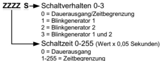
**Beispiel:** An Ausgang 1 und 2 soll eine Weiche angeschlossen werden, die über die Adresse 10 geschaltet werden soll. Hierbei soll der Ausgang 1 die Weiche in Abzweigung (rot) und Ausgang 2 die Weiche in nicht abzweigende Stellung bringen (grün).
