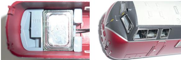
**Bild oben:** Der obere Teil des Führerstandes einer V 200 der Spurweite N dient als Resonanzraum. Die Lautsprechermembrane des Miniaturlautsprechers 31101 strahlt dabei nach unten zum Drehgestell ab.
